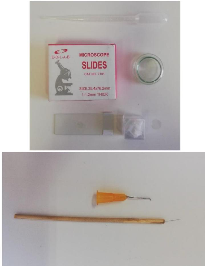
Figura 2. Elementos que se utilizan durante el montaje de Sifonápteros de la Colección de Ectoparásitos como portaobjetos, cubreobjetos, pipeta y placas Petri, aguja hipodérmica y aguja entomológica que se utilizan para manipular los especímenes y realizar la punción.
